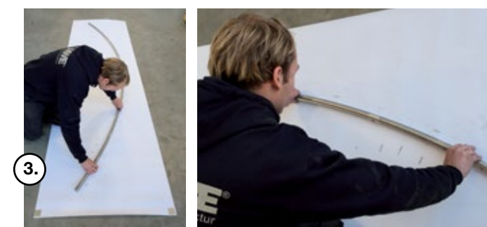
3. Der gefertigte Laufschienenbogen wird passgenau auf der Technikzeichnung ausgelegt und mit der Zeichnung abgeglichen.
